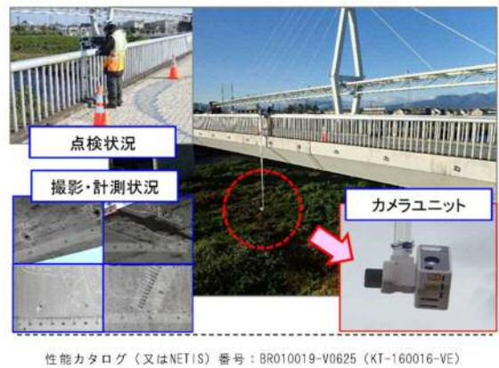
活用例3：ドローン技術を活用した高所の損傷状況の
