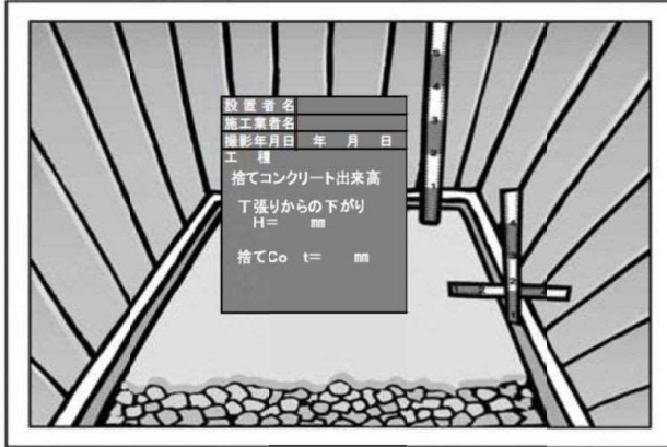
写真(捨てコンクリート打設状況 例1)
