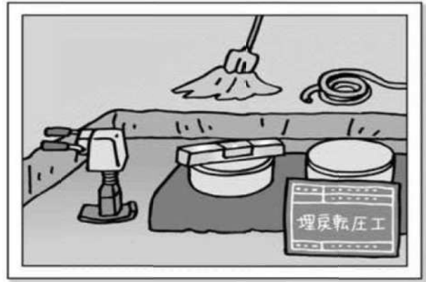
写真(埋戻し転圧状況)
