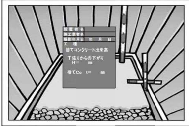
写真(捨てコンクリート打設状況 例1)
